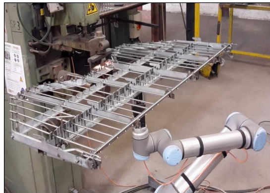
Bras Robotique + Soudage par point
